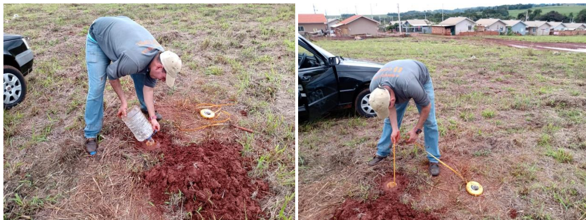
Figura 5: Fotos da realização dos ensaios de percolação.
