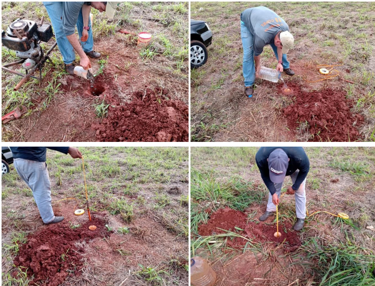
Figura 6: Fotos da realização dos ensaios de percolação.
