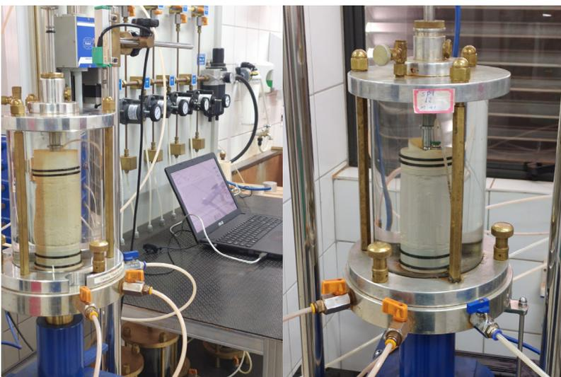
Figura 3 – Amostras indeformadas sob ensaio
