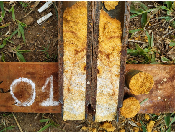
Figura 3 - Sonda com solo da Camada 2 (Furo 01)
