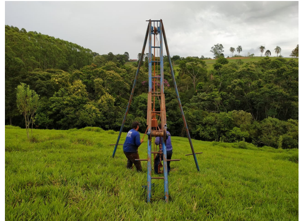
Figura 2 - Execução do serviço de sondagem
