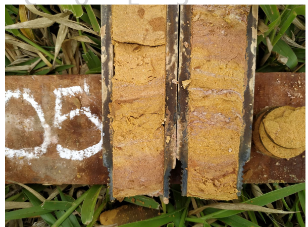
Figura 6 - Sonda com solo da camada 2 (Furo 05)
