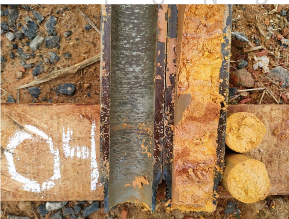
Figura 5 - Sonda com solo da Camada 2 (Furo 04)
